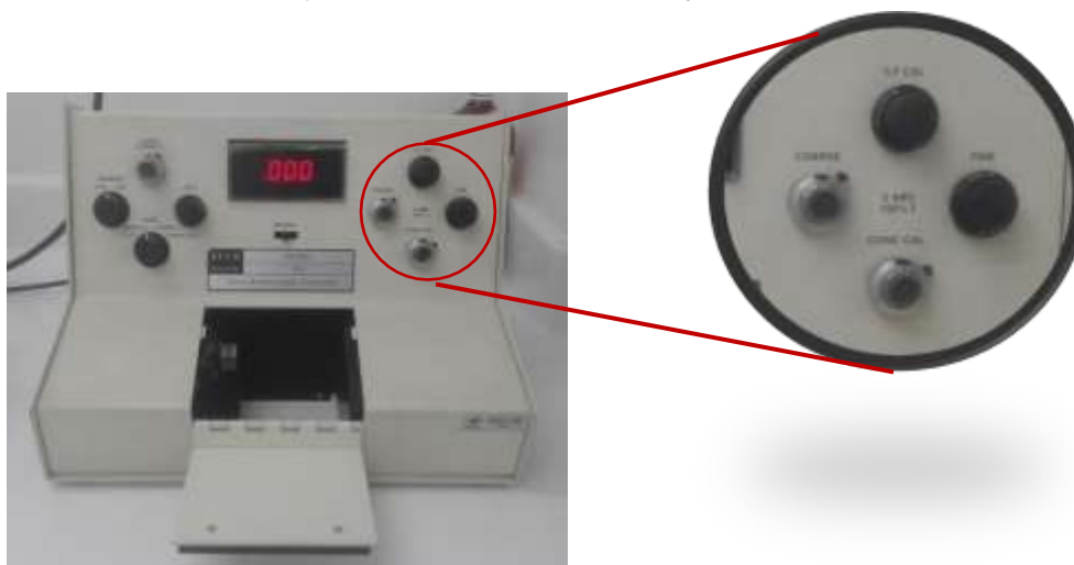
Figura 2. Equipo Buck Scientific HCH 404 ajustado a 0.00, a la derecha panel de ajuste.
