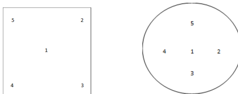
Figura 1. Orden y ubicación de la pesa para realiza la prueba de excentricidad dependiendo de la forma del platillo de la balanza.
