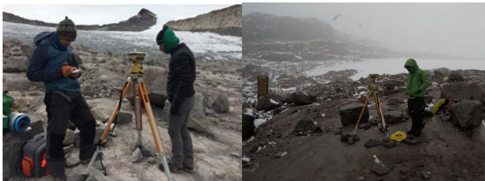
*Receptor base y receptor móvil del levantamiento topográfico con GPS diferencial. IDEAM, 2018.*
