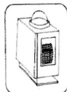
Registra en forma continua la radiación solar global incidente sobre una superficie horizontal, en calorías por centímetro cuadrado.
