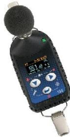
Se verificó la calibración antes y después de cada evaluación con el pistofono Modelo QC – 20 y serial QO1110021 con el fin de darle mayor confiabilidad a las evaluaciones.
