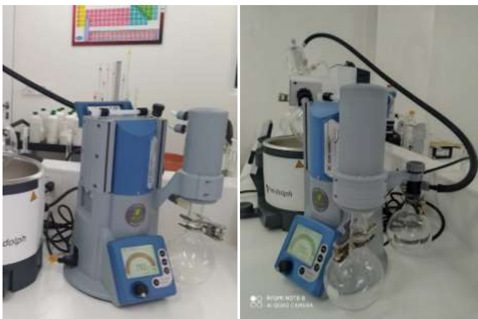
Figura 5. Correcto ensamble de la bomba de vacío Vacuubrand, modelo PC 3001 VARIO PRO acoplada al rota-evaporador.
