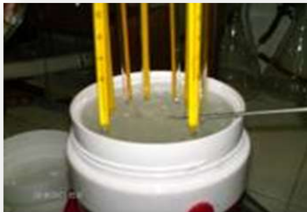
Figura 2. Ejemplo de montaje para verificar temperatura a punto de hielo.
