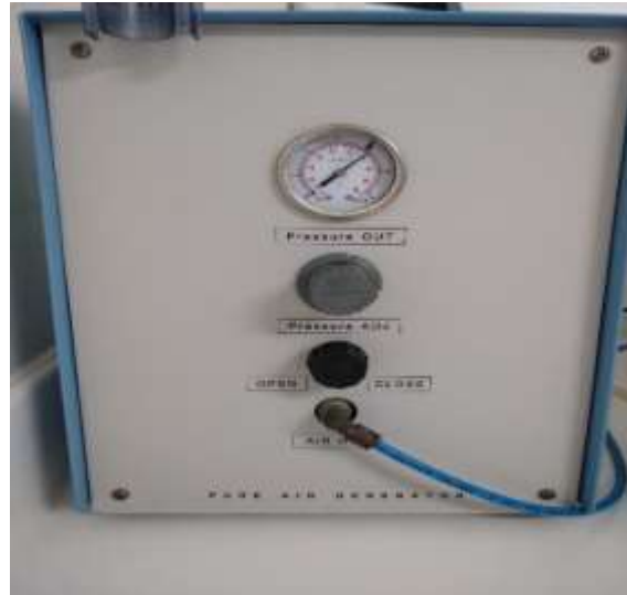
La presión de entrada de DMA-80 debe ser de 400 kPa; 4 bar (60 psi).
