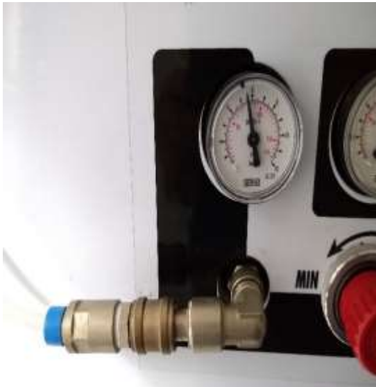
Compresor: la presión de salida debe estar en 5-7 bares (70 -100 psi).
