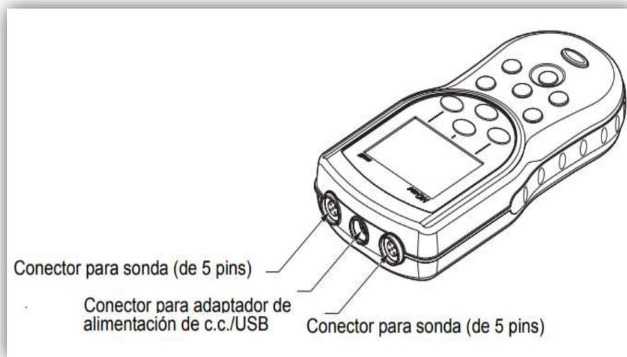
Los datos pueden transmitirse a un PC, una impresora o una memoria "Flash Stick" por medio del adaptador de c.c./USB.
