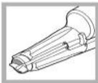
5. Inspeccione la superficie del sensor de la sonda LBOD. Si está mojada, séquela con un trapo que no sea abrasivo.
