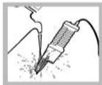
2. Aclare la cápsula del sensor con agua desionizada y séquela.
