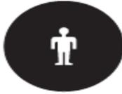
Utilice la tecla **ID DE USUARIO** para asociar las medidas de la muestra con una persona. El ID del usuario aparecerá en la esquina inferior izquierda de la pantalla; todos los datos memorizados incluirán este identificador. Si no se introduce un ID de usuario, la pantalla muestra tres guiones.
