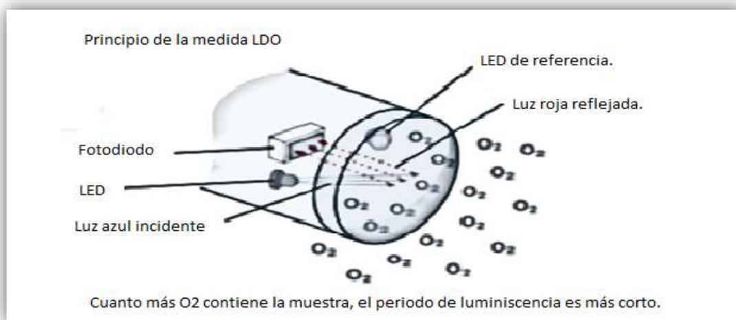
La sonda mide cuánto tiempo tarda el material luminiscente en volver a un estado relajado. La sonda calcula la concentración de oxígeno disuelto (OD) comparando las medidas de vida de las emisiones de luz azul y roja. Los medidores HQd se conectan con sondas inteligentes que reconocen automáticamente el parámetro de prueba, el historial de calibración y la configuración del método para minimizar los errores y tiempo de instalación.
