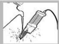
6. Quite la sonda del frasco de DBO. Asegúrese de no enganchar la paleta agitadora en el labio interior del frasco. Coloque con cuidado el tapón en el frasco.
