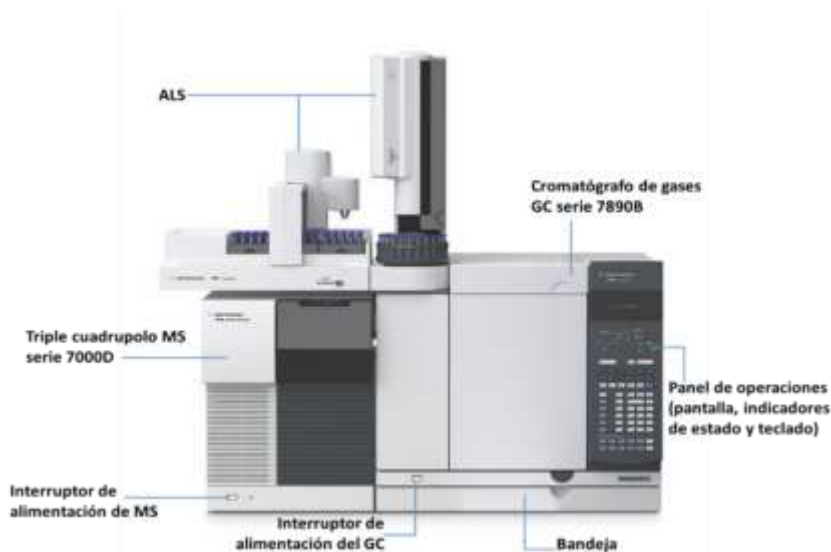
Figura 1. Sistema de triple cuadrupolo Agilent 7000D, con cromatógrafo de gases Agilent 7890B y muestreador automático de líquidos ALS.
